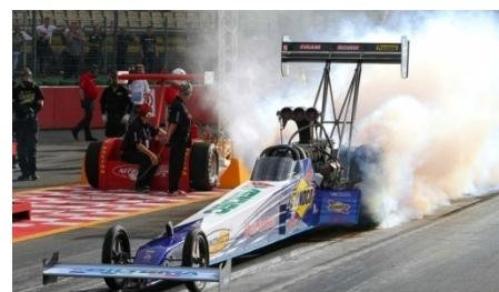
Нитрометан может быть использован как монотопливо, то есть топливо, способное гореть без добавки кислорода. Огромное преимущество нитрометана в том, что он дает гораздо больше мощности с каждым взрывом в двигателе. В равных объемных долях взрыв нитрометана выделяет меньше энергии, чем взрыв бензина, но при одном и том же объеме цилиндра за единицу времени нитрометана горит гораздо больше. Как результат — ощутимый прирост мощности за каждый такт.
